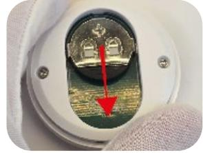
Entnehmen Sie die Batterieeinheit aus dem Gehäuse.
