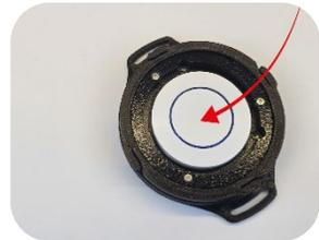
Legen Sie den zuvor entfernten Halte-Ring wieder in den EASY-Taster 2 ein und ziehen Sie die drei T6-Schrauben mit dem mitgelieferten Schraubendreher fest an. Ein korrektes Anziehen der Schrauben sorgt dafür, dass alle Bauteile sicher sitzen und der Deckel später zuverlässig einrastet.
