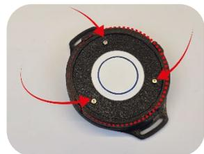
**Montieren Sie den Deckel**, indem Sie ihn so ausrichten, dass er auf den äußeren Ring des EASY-Taster 2 passt. Er kann in vier verschiedenen Positionen angebracht werden – jeweils in 90°-Schritten gedreht.
