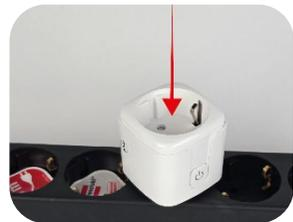
Achten Sie darauf, dass das rote Licht der Funk-Steckdose **nicht leuchtet (die Funk-Steckdose also ausgeschaltet ist)**. Schalten Sie sie gegebenenfalls aus.
