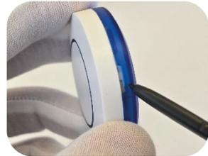
Legen Sie den Funksender wieder in den Boden des EASY-Taster 2 ein.
