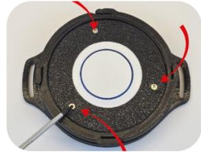
Entfernen Sie den innenliegenden Halte-Ring, indem Sie den EASY-Taster 2 vorsichtig umdrehen und entnehmen Sie den Funksender (erkennbar am blauen Boden).
