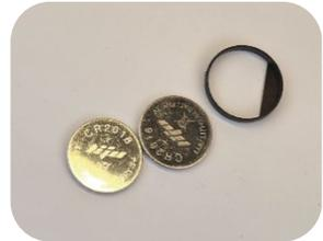
Legen Sie die Batterieeinheit wieder in den Funksender ein. Stellen Sie sicher, dass die Batterien korrekt fixiert sind und der Pluspol weiterhin nach oben zeigt.
