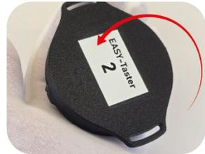
**⚠ Achtung:** Beim Umdrehen können der Halte-Ring sowie der Funksender herausfallen. Arbeiten Sie deshalb idealerweise auf einer weichen Unterlage, um Beschädigungen zu vermeiden.
