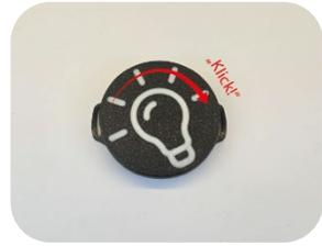
Die Batterie des EASY-Taster 2 wurde korrekt gewechselt.
