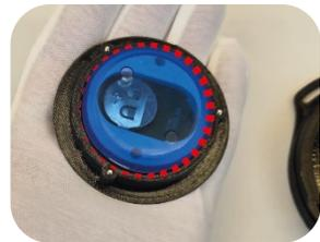
Öffnen Sie den Funksender, indem Sie das blaue Unterteil vorsichtig mit einem flachen Werkzeug ab-hebeln. Dafür befindet sich an der Seite des Senders eine kleine Kerbe im Kunststoffgehäuse.
